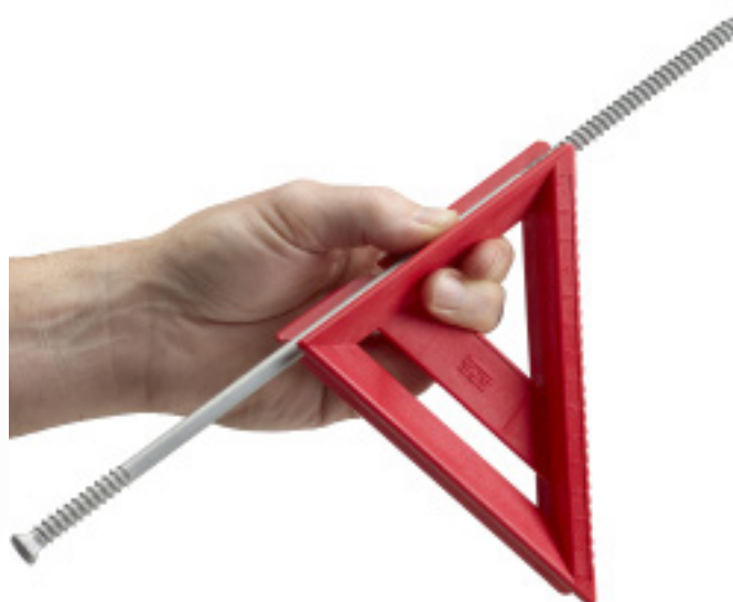
PAROC ZEROfix Vinkelverktøy (XTI 001) er beregnet for montering av Fasadeskrue HECO Topix-plus Therm (XFS 006) i vinkler på henholdsvis 30 og 45 grader.
