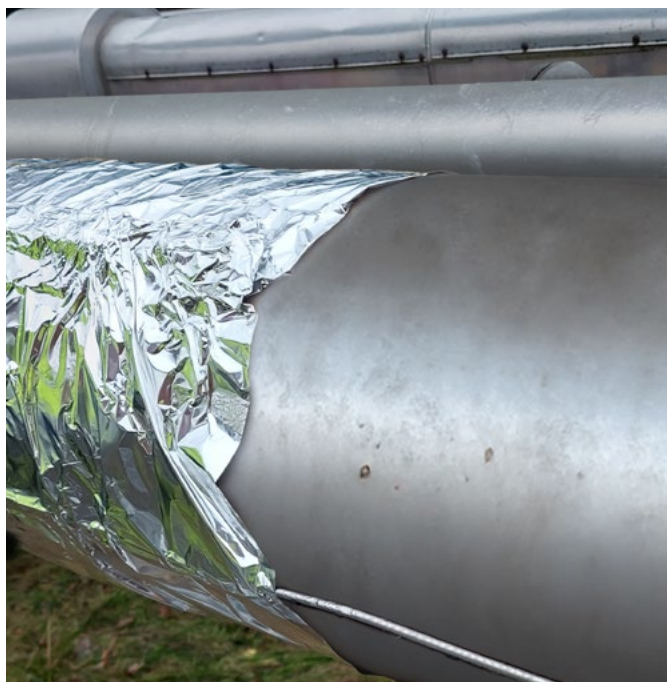
KONVENTIONELLE METHODE MIT SEPARATER ALUMINIUMFOLIE ↑
